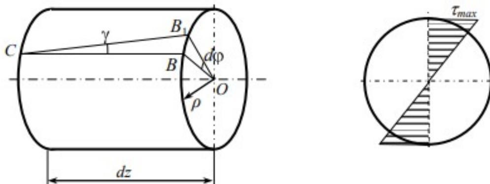
При кручении происходит поворот одного сечения относительно другого на угол закручивания -  $\phi$ .
