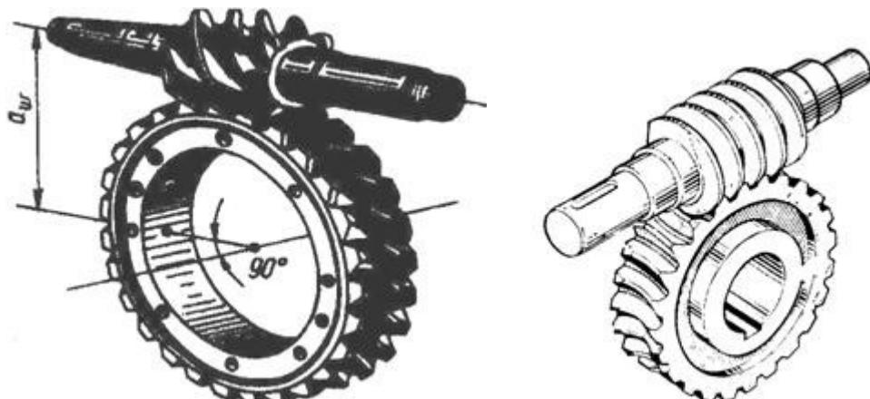
Геометрия червячных передач. В червячной передаче, так же как и в зубчатой, различают диаметры начальных и делительных цилиндров (рис. 2.11):  $dw_1$ ,  $dw_2$  – начальные диаметры червяка и колеса;  $d_1$ ,  $d_2$  – делительные диаметры червяка и колеса. В передачах без смещения  $dw_1 = d_1$ ,  $dw_2 = d_2$ . Точка касания начальных цилиндров является полюсом зацепления.
