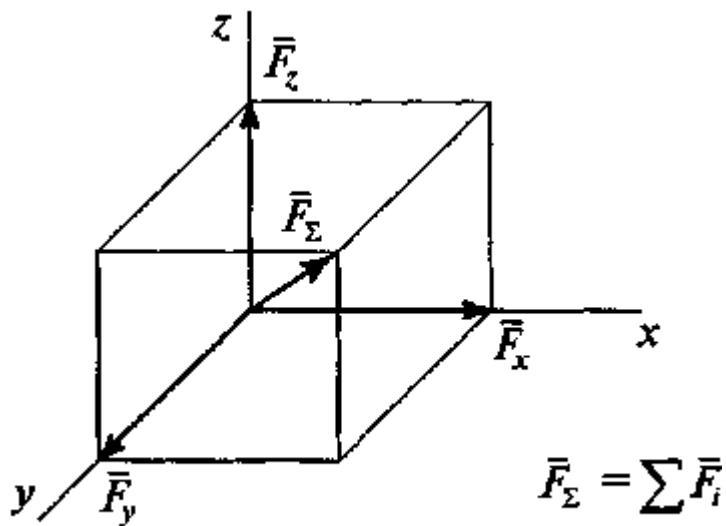
Условие равновесия пространственной системы сходящихся сил: алгебраическая сумма проекций всех сил на три взаимно перпендикулярные оси координат должны быть равны нулю, т.е.
